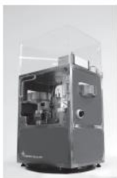
Electrophorèse capillaire pour détecter les contrefaçons (Méthode pour déceler les contrefaçons de médicaments)
